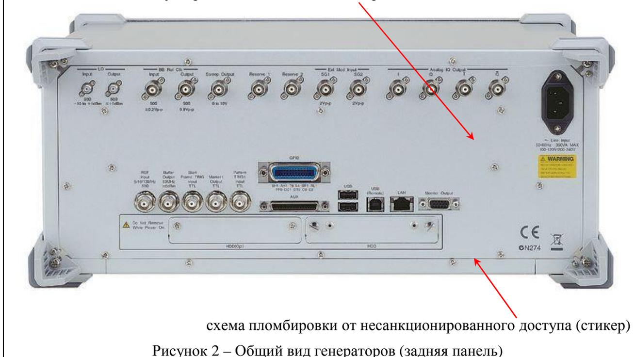
схема пломбировки от несанкционированного доступа (стикер)
