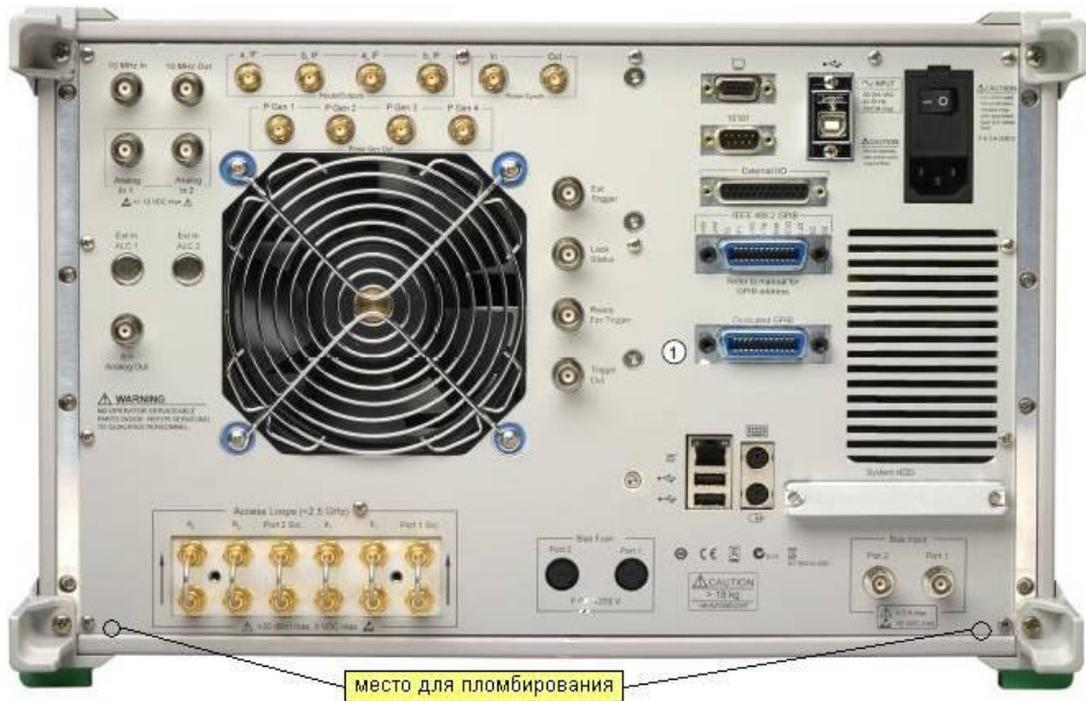
Рисунок 2 – Задняя панель анализатора и места для пломбирования.
